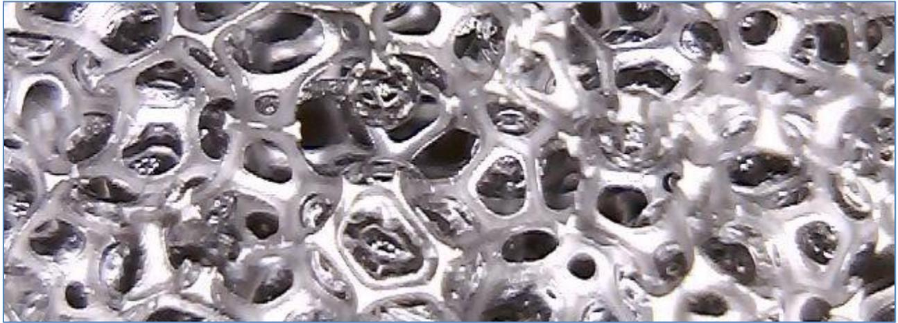
Wasserstoff-Entwicklung an Nickelschaum-Elektrode
