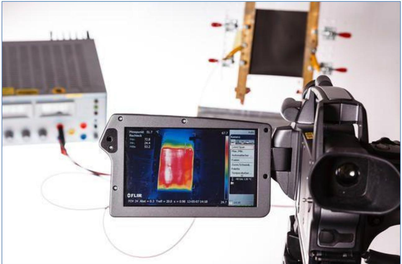
Um die Heizwirkung der Folien für Pkw zu analysieren, schlossen die Forscher sie an eine Spannungsquelle an und
