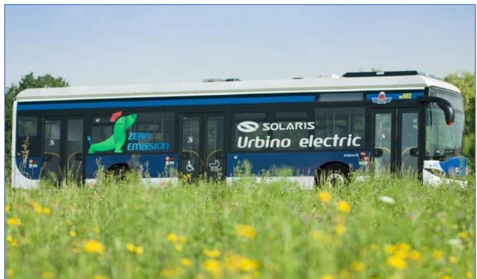
tragung verlegt. Vergleichbar mit einer elektrischen Zahnbürste versorgten sich die Solaris-Busse des Typs Urbino 12 electric ohne Kabelkontakt mit der nötigen Energie. Durch Übertragungsleistungen von bis zu 200 Kilowatt seien an den jeweiligen Endpunkten der Linie nur Ladezeiten von wenigen Minuten notwendig. Die Busse seien so ausgelegt, dass sie – etwa bei Verspätungen durch Staus – auch eine bis zwei Nachladepausen auslassen könnten und trotzdem einsatzfähig blieben.
